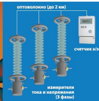
i-TOR может работать с любыми счётчиками, применяемыми в системах АИСКУЭ и обеспечивать точный учёт параметров электроэнергии в любой точке сети. Оригинальные решения позволяют не только вести коммерческий учёт, но и передавать информацию в систему АИСКУЭ через GSM или радиоканал.
