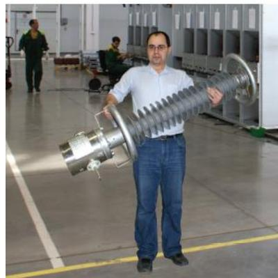
Полноценный измерительный комплекс для измерения тока и напряжения в сети 110 кВ обладает уникальными массо-габаритными показателями. Вес фазы всего в 60 кг позволяет снизить затраты на установку аппарата в сети и издержки при обслуживании.
